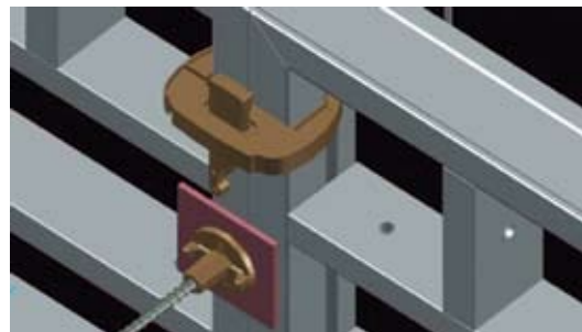
Рис. 2. Пример скрепления щитов с помощью клинового замка
